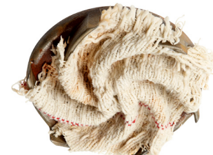
Figuur 7: Ophopingen in een vortexwaaier
