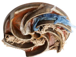
Figuur 6: Ophopingen in een vortexwaaier
