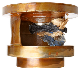
Figuur 4: Ophopingen in een eenkanaalwaaier
