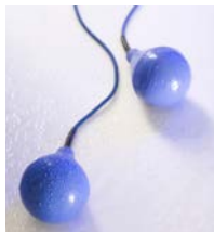
Nivåregulatorer från Flygt Styr pumpstart och pumpstopp utgående från faktiska vattennivåer och/eller aktiverar en larmanordning.
