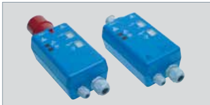
Flygt Pumpenstartgeräte (manuell und automatisch) Bietet thermischen/magnetischen Überstromschutz, Thermo-Kontaktüberwachung und Phasenfolgeanzeige.
