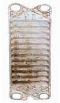
Wärmetauscher bei Einsatz von Ozon
