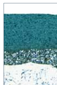
Querschnitt der Flygt-Epoxidharzbeschichtung
