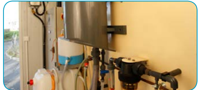
In der Prozesstechnik: TetraCon® 700 IQ F Leitfähigkeitssensor mit 4-Elektroden-Messzelle
