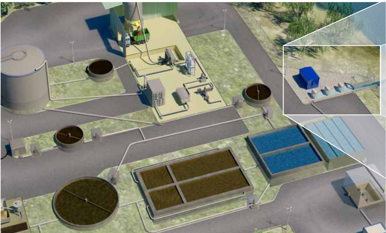
Übersicht einer typischen Kläranlage mit WEDECO TAK 55 UV-Desinfektion als letzte Aufbereitungsstufe
