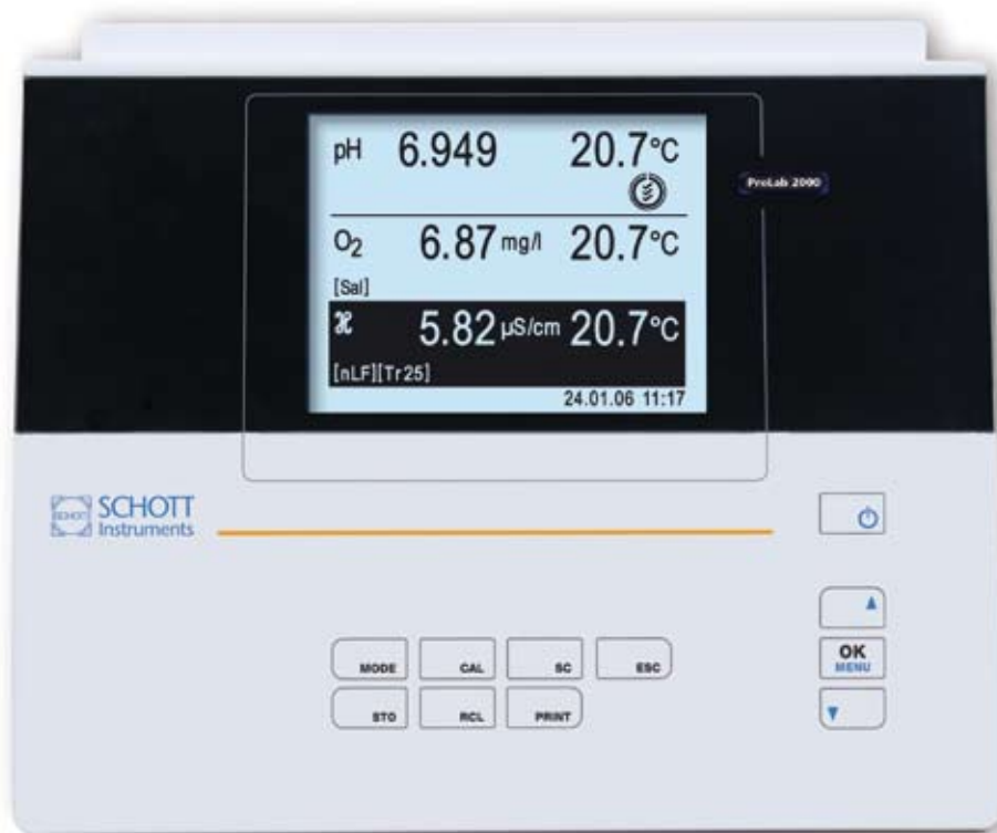
Abb. 2: ProLab 2000, das Multiparameter-Messgerät kann drei Messgrößen gleichzeitig messen und anzeigen.
