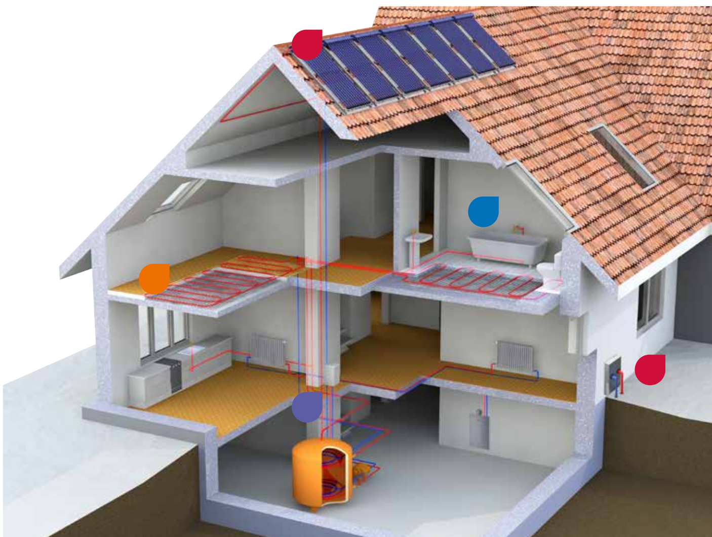
Sistema com válvulas termostáticas de radiador
