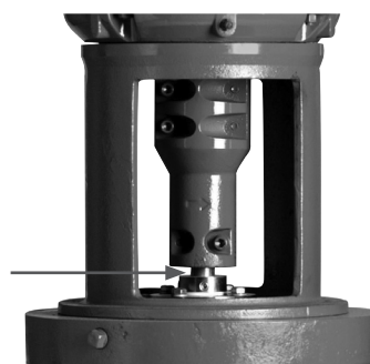
Figura 30: Patrón de torsión del acople Figura 30a: Ubicación de medición de holgura
