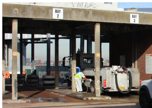
Una delle autocisterne aeroportuali del trasporto reflui, per il trasferimento dei liquami all'Unità sanitaria centrale.
