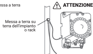
Messa a terra
